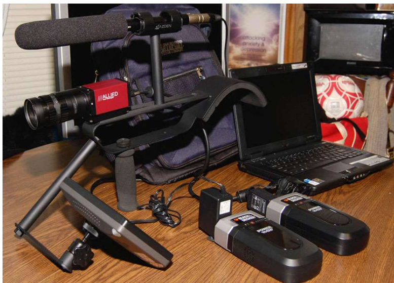
Ejemplo de Cámara de Visión Artificial adaptada a la grabación de cine digital ( www.davidrubio3d.com ).
